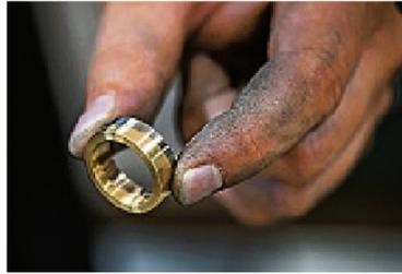
Soll ein Ring aus zwei verschiedenen Materialien bestehen, werden diese mit hohem Druck zusammengepresst.
